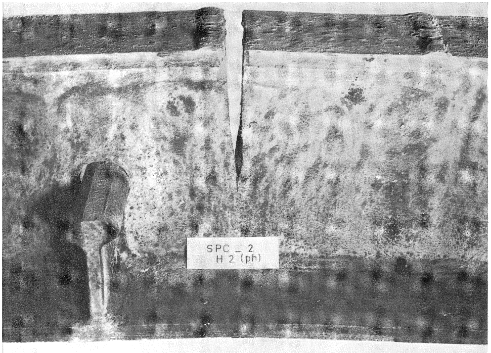
Fig. 5. Breuk van een ligger na 34 dagen ( 6,3 \times 10^6 wisselingen), besproeid.
