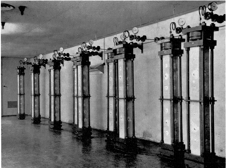
Fig. 6. Opstelling in het kruiplaboratorium van een serie prisma's, die onafhankelijk van elkaar tot verschillend percentage van de breukbelasting onder druk gehouden worden. Met afneembare rekmeters wordt periodiek de verkorting tussen de meetpunten bepaald.
