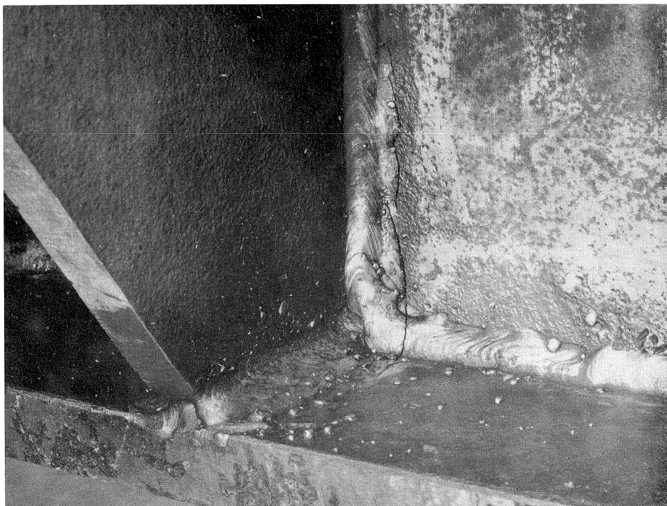
Fig. 3. Scheur na 3-puntsbuigproef, geen laspoortjes.
