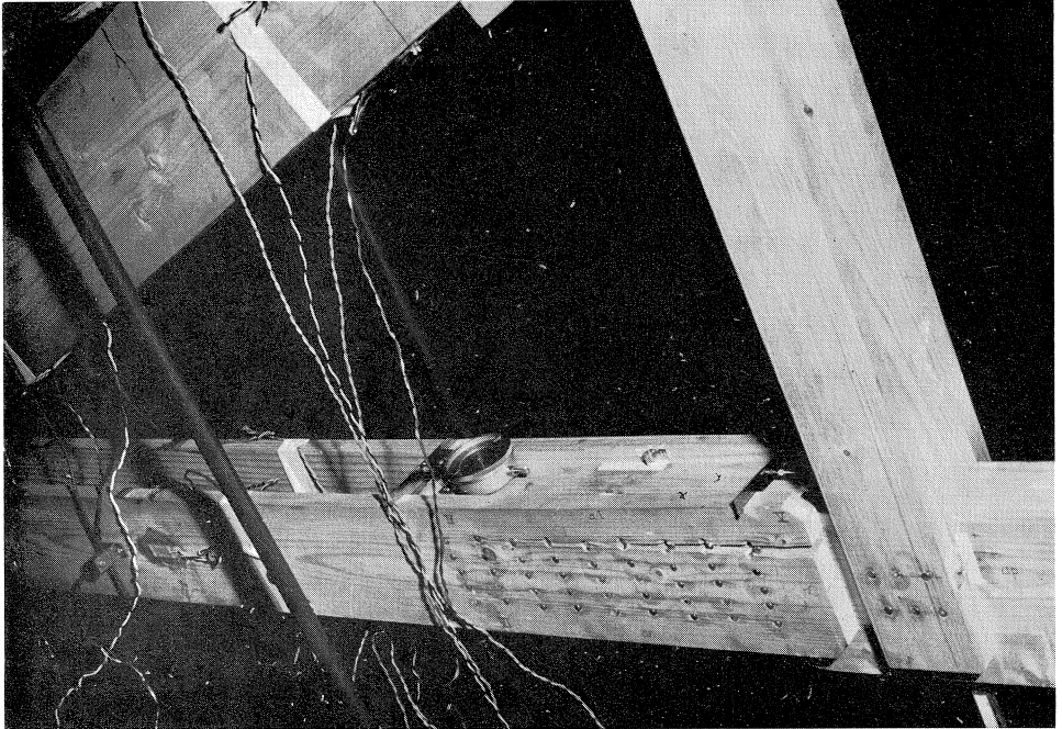
Fig. 6. Genagelde verbinding op het punt te bezwijken.
