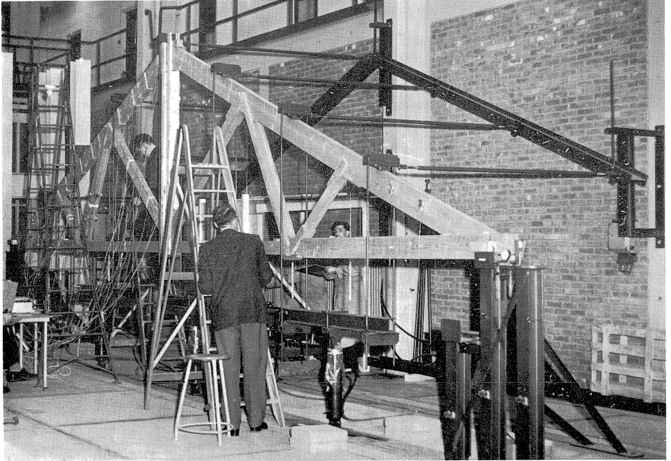
Fig. 5. Genageld vakwerkspant tijdens beproeving.
