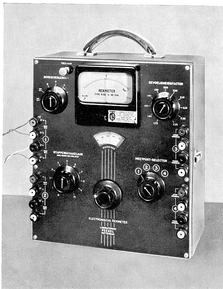
Fig. 7. Meetapparaat voor metingen bij statische belastingen.
