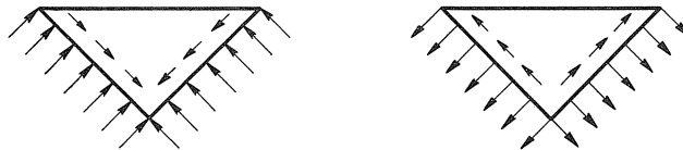
Fig. 11. Belasting van de flanklassen veroorzaakt door spanningen loodrecht op het vlak van de strippen. De spanningen, die in de linkerhelft van de figuur zijn aangegeven, gelden voor de lasdoorsnede aan het bovineinde; rechts zijn de spanningen in de lasdoorsnede aan het onderende aangegeven.
