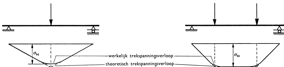
Fig. 4. Trekspanningsverloop bij een driepunts- en een vierpuntsbuigproef.
