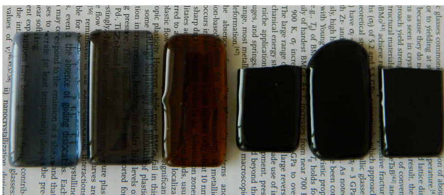
Figure 5: The samples containing slag. From the left to the right: 77.5KPO_3-10Slag-12.5Al_2O_3 , 75KPO_3-12.5Slag-12.5Al_2O_3 , 70KPO_3-15Slag-15Al_2O_3 , 65KPO_3-17.5Slag-17.5Al_2O_3 , 65KPO_3-20Slag-15Al_2O_3 , 60KPO_3-20Slag-20Al_2O_3 .
