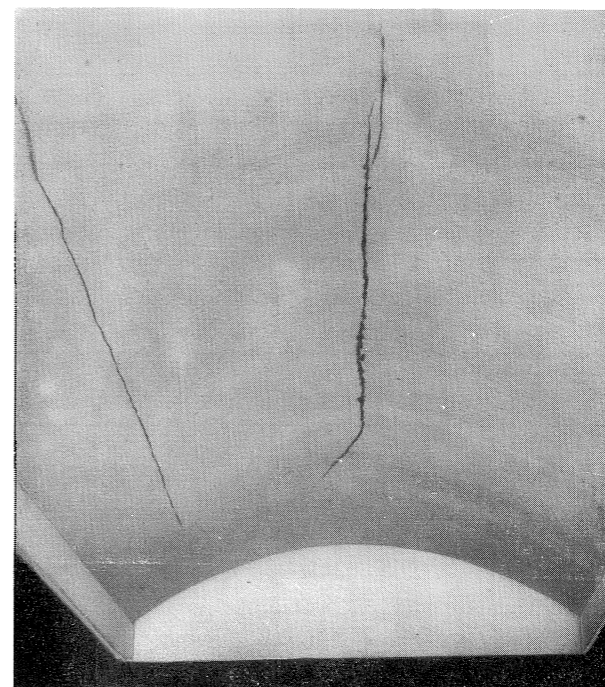
Fig. 21. Schaal A7 na bezwijken, gezien van de onderzijde.
